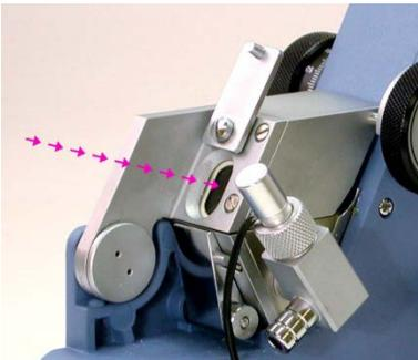
Abra el disparador en el prisma superior y eleve el espejo del prisma inferior. Esto permitirá que la luz pase a través de la muestra y el prisma superior.
