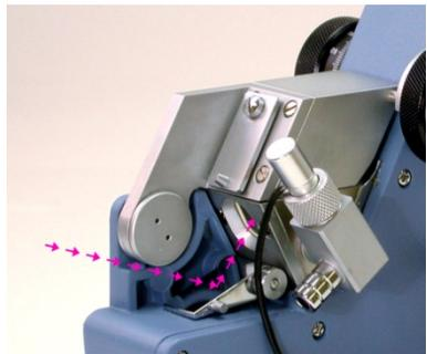
Cierre el disparador en el prisma superior y baje el espejo del prisma inferior. De esta manera la luz se reflejará en la parte inferior de la muestra.
